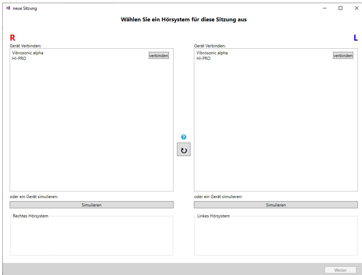
Im Beispiel ist für beide Tragseiten ein **Vibrosonic alpha** über einen **HI-PRO**-Programmieradapter mit dem PC verbunden.
